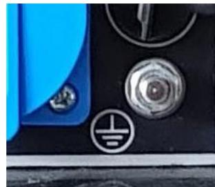
Il terminale di messa a terra è progettato per prevenire scosse elettriche collegandolo al filo di terra. Il generatore deve essere adeguatamente messo a terra prima del funzionamento, utilizzare un filo di rame con un diametro uguale o superiore a quello del cavo di alimentazione dell'apparecchio collegato.
